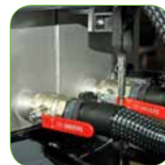
Der Absperrhahn am Ablassschlauch ist serienmäßig.
